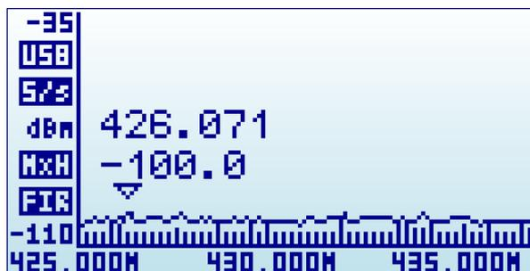
**说明：** RF Explorer 频谱分析仪主界面显示时，使用左、右箭头按键可提高或降低 Start/Stop（起始/终止频率）；每按下左或右箭头按键一次，频谱显示范围会左移或右移 25%。这种操作便于快速偏移显示范围，而无需输入数值。
