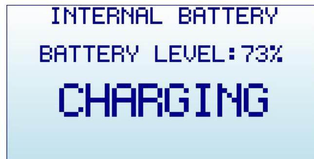
此时，您可以按 ENTER 键或 RETURN 键关闭此屏幕。在按下按钮保持超过 15 秒后，装置会被自动设置为休眠模式（SLEEP MODE），除充电和最小 CPU 监控电路外，所有内部电路和 LCD 背光都会熄灭，这便是建议的夜间装置充电过程。注：为清楚起见，当 LCD 背光关闭时，将会显示如下黑/白屏幕图像。
