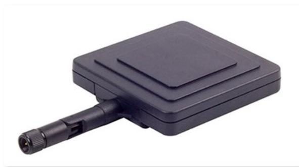
定向贴片天线是一种高增益天线，是使用 RF Explorer 分析仪进行特定方向扫描的绝佳选择。与诸如偶极型的全向天线相比，贴片天线正面具有 8dBi 增益。其包括一个实体 SMA 连接器（并非市面上大多数的 RP-SMA），因此非常适合所有 RF Explorer 型号。
