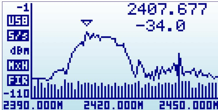
X 轴代表频率，单位是 MHz；Y 轴代表实际接收功率，单位是 dBm 或 dBuV（可选设）。以上图为例，频带宽度从 2390MHz 到 2450MHz（即 60MHz 范围），且幅度显示范围从 -1dBm 到 -110dBm。
