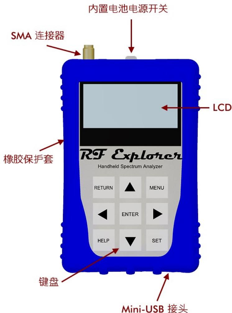
RF Explorer 的 Plus 机型正面配有 9 个功能键，包括提供帮助信息的 HELP 按键以及便于进行预设置的 SET 按键。另外，该机型还配有至少一个 50 欧姆阻抗的 SMA 标准射频接头。
