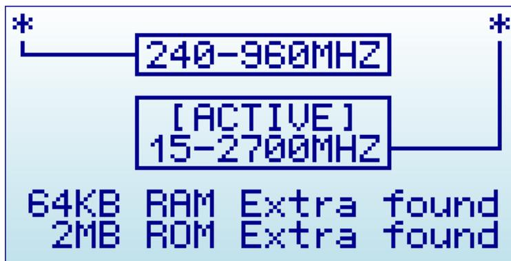
**重要提示：**在任何特定时间内，只能启用两个 SMA 连接器中的一个。您可以使用“[频率菜单](#)”中的“模块”（Module）选项选择一个激活的连接器；详情请参见第 14 页。
