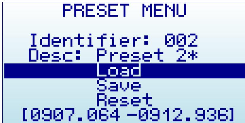
预设置功能方便用户存储和恢复多个配置。仅在部分机型提供此功能：RF Explorer 的 Combo 机型（固件为 v1.26 或更新）以及 RF Explorer 的 Plus 机型。
